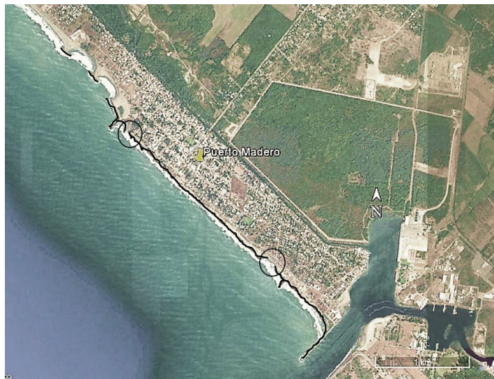
Figura 11. Puerto Madero. En negro se muestra la barrera de piedras y bloques de concreto que protegen a la comunidad. Los círculos muestran áreas donde la barrera de piedra ha desaparecido.
